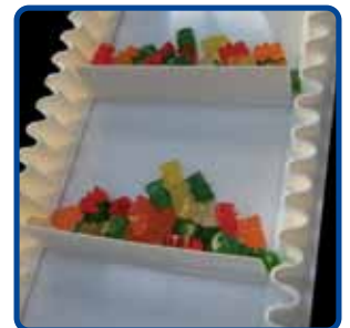
Foratura - Applicazione profili Guide di contenimento bordi sigillati
